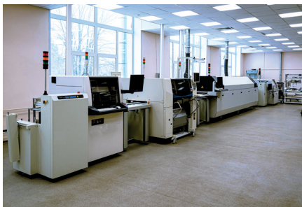
Линия поверхностного монтажа печатных плат
