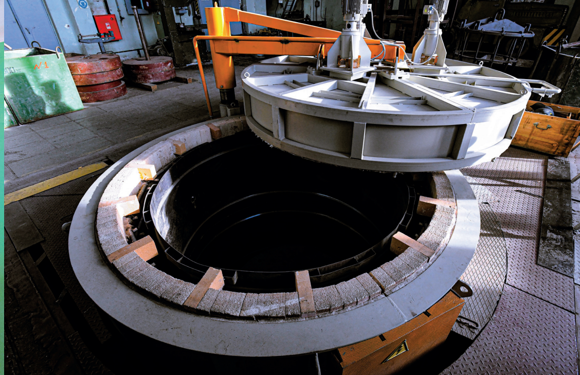
▲ Шахтная печь для термической обработки деталей с размерами L \approx 3000 мм, диаметром \approx 2000 мм
