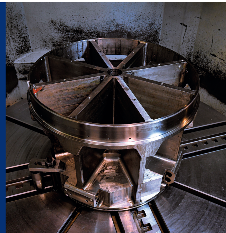
Катушка из титанового сплава для испытательного стенда
