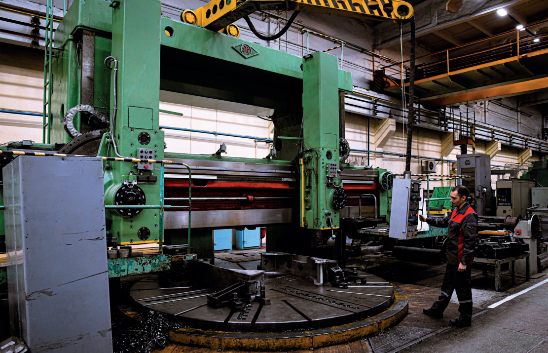
▲ Участок механической обработки. Токарно-карусельный станок «Коломна»
